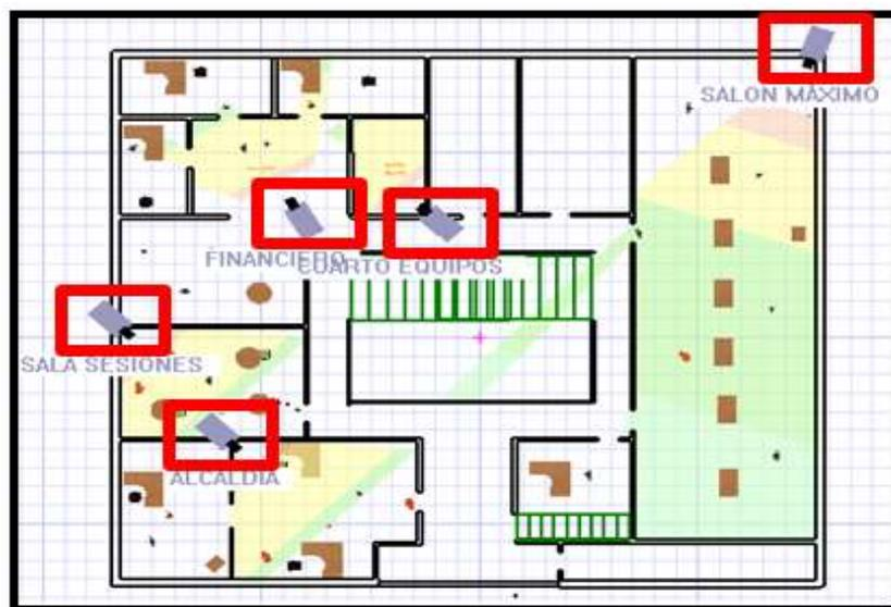
**Figura 29:** Ubicación de cámaras IP en del Edificio Principal Primer Piso
