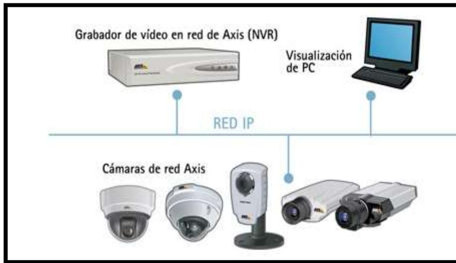
**Figura 3.** Plataforma Basada en NVR
