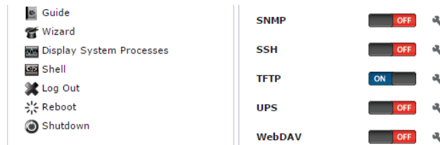
Figura 0-135. Activación del servicio TFTP en el servidor FreeNAS.
