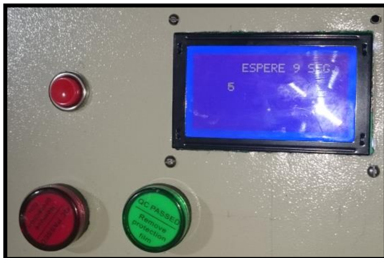
Figura 65 Tiempo de espera en GLCD para colocar pezoneras Fuente: Autor
