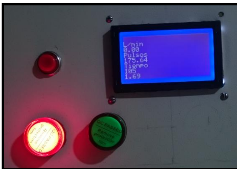
Figura 69 Luz piloto activado para indicar fin de proceso de extracción de leche Fuente: Autor
