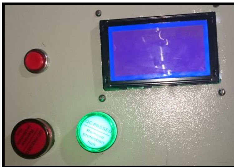
Figura 66 Luz piloto activado para inicio de proceso de extracción de leche Fuente: Autor
