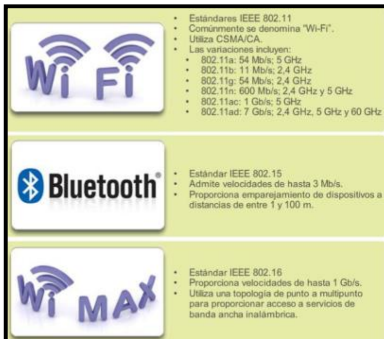
Figura 20 Diferencias entre los medios inalámbricos Fuente: CISCO. Principios básicos de enrutamiento y switching. CCNA1 V5
