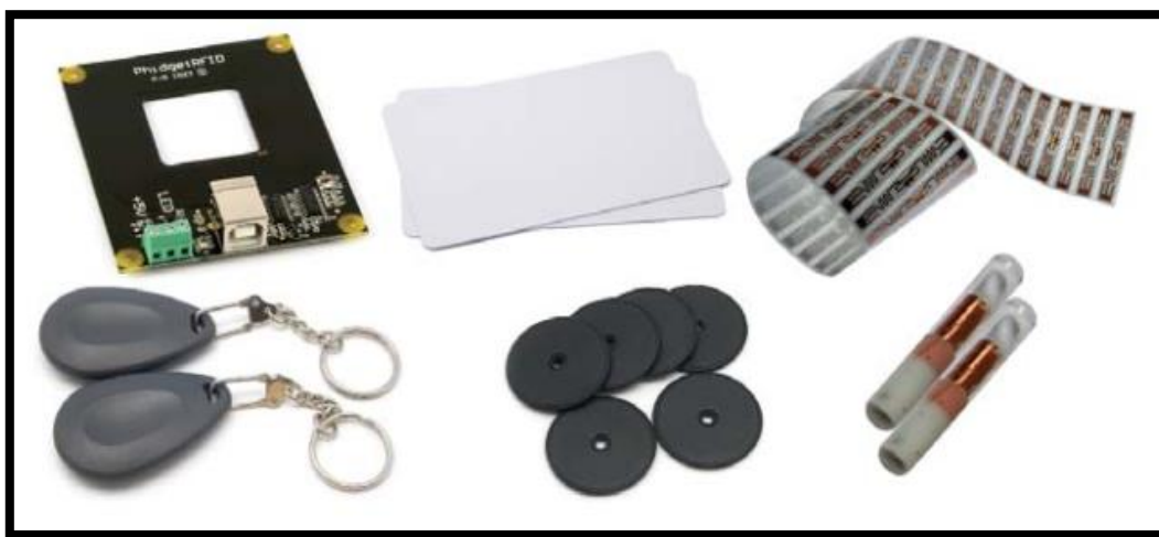
Figura 25 Ejemplos de tags de diferentes formas y tamaños Fuente: AETIC, O. Y. La tecnología RFID: Usos y oportunidades
