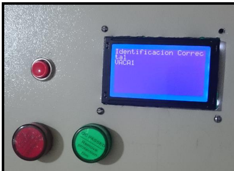
Figura 63 Mensaje de “Identificación correcta” del bovino en GLCD Fuente: Autor
