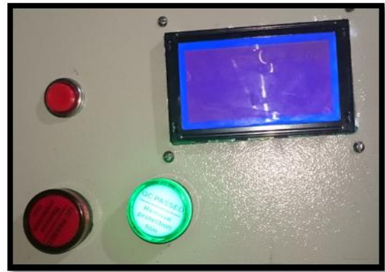
Figura 25 Luz piloto activado para inicio de proceso de extracción de leche
