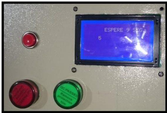
Figura 24 Tiempo de espera en GLCD para colocar pezoneras
