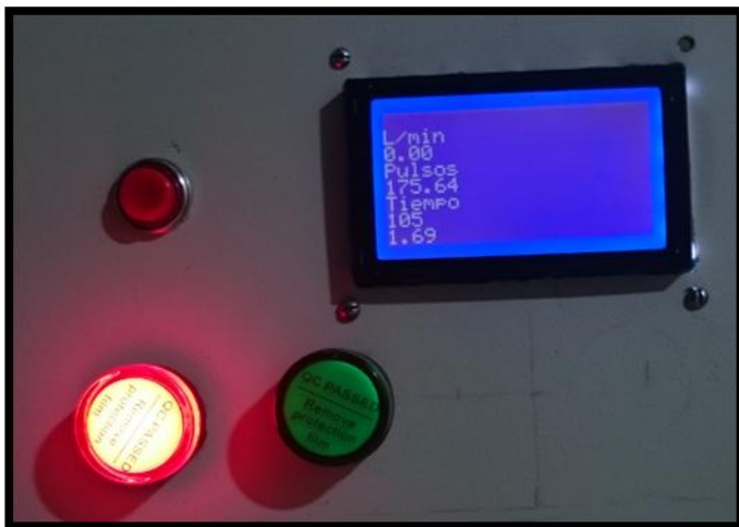
Figura 28 Luz piloto activado para indicar fin de proceso de extracción de leche
