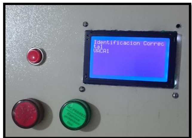
Figura 22 Mensaje de "Identificación correcta" del bovino en GLCD
