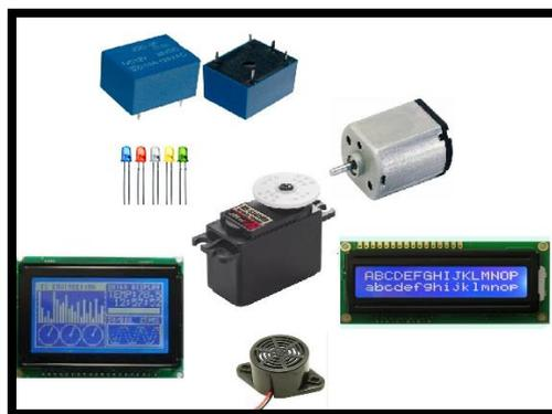
Figura 38. Ejemplos de Actuadores Electrónicos
