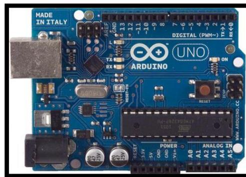
Figura 13. Placa Arduino UNO
