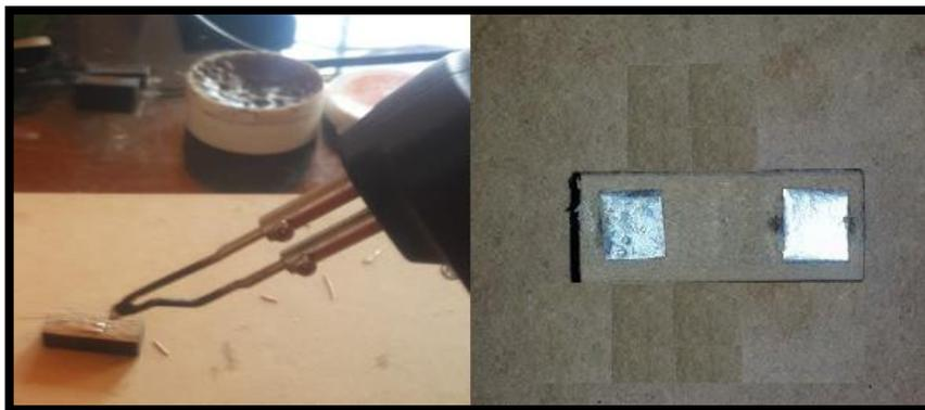
Figura 113. Proceso de elaboración de las fichas, soldado de placas metálicas
