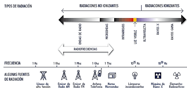
Fig. 1. Bandas de Frecuencia del Espectro Radioeléctrico
