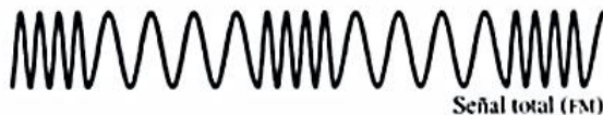
Fig. 14: Resultado de la señal FM estructurada por la portadora y la señal de audio.
