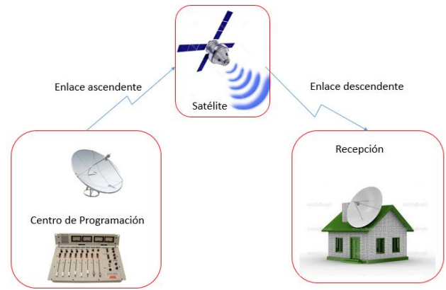
Fig. 3: Esquema de Radiodifusión Satelital
