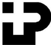
Figura 56. Símbolo opcional para indicar el puerto de potencia o salida.
