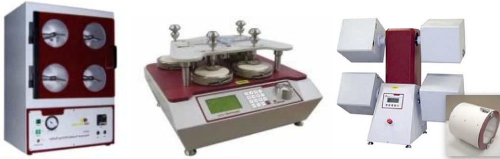
Figura 13. Equipos para Ensayar el Pilling (Izq: Random Tumble Pilling. Cen: Martindale. Der: ICI )
