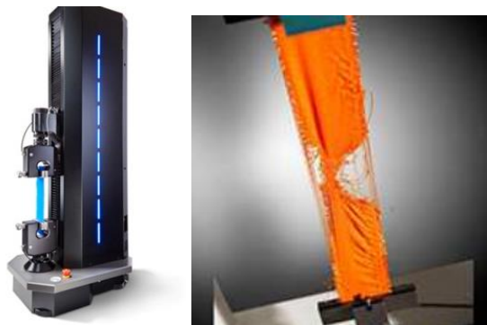
Figura 18. Equipo para la Resistencia a la rotura (Dinamómetro)
