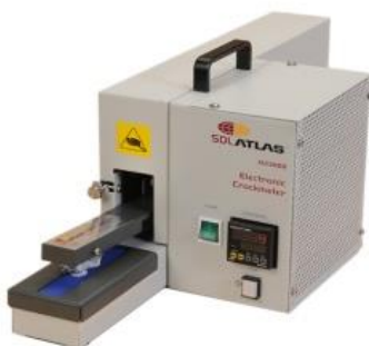
Figura 22. Equipo para la solidez al frote (Crock meter)
