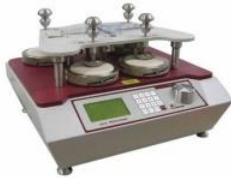
Figura 14. Equipo para determinar la Abrasión (Martindale)
