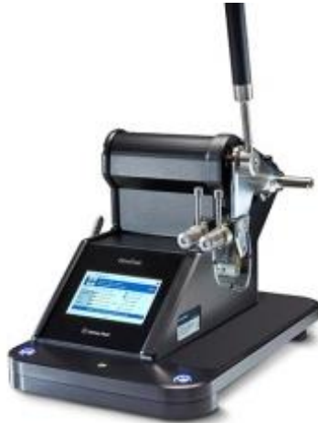
Figura 17. Equipo para determinar la resistencia al desgarro (Helma Tear)
