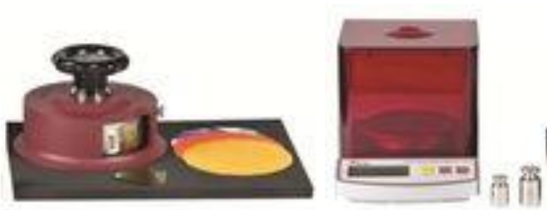
Figura 12. Herramientas para el control del Peso (Cutter: izquierda y Balanza: derecha)
