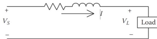
Figura 14 Componentes de la impedancia de línea
