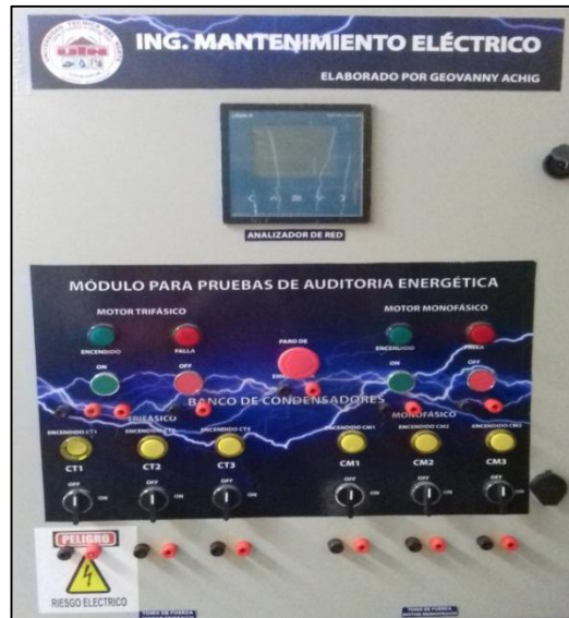
Figura 101: “Modulo para pruebas de Auditoria Energéticas”
