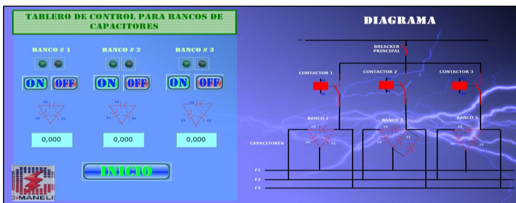
Figura 83: Control de bancos de capacitores (MOVICON 11.5)
