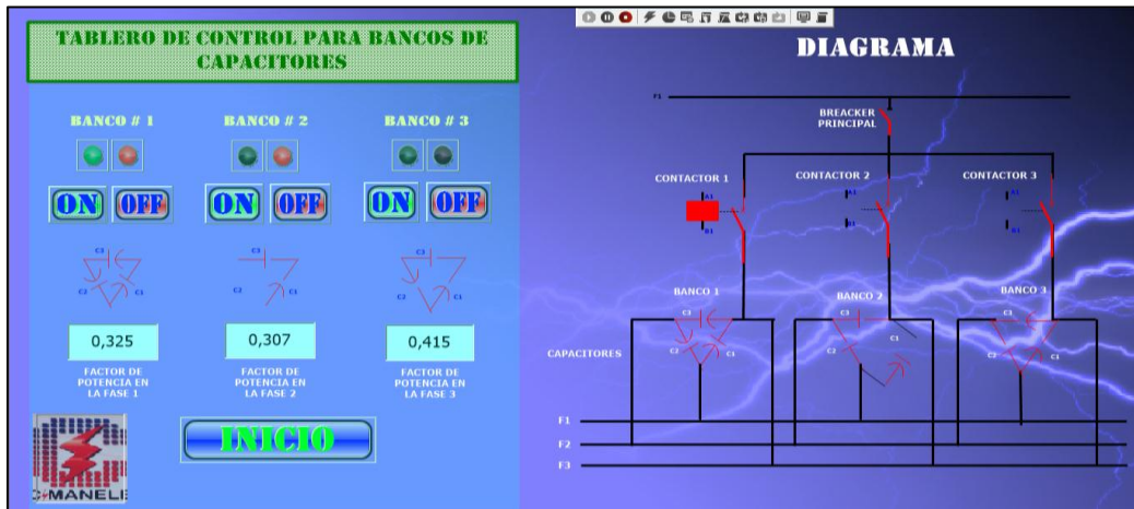
Figura 93: Factor de Potencia, Banco 1 Encendido (MOVICON 11.5)
