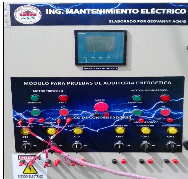
Figura 59: Módulo Para Pruebas De Auditoria Energética
