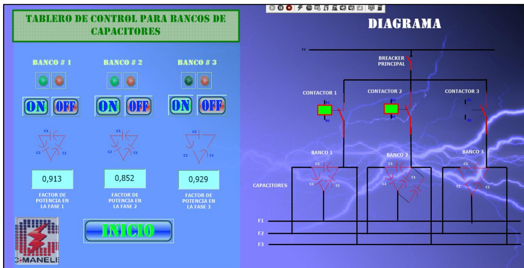
Figura 94: Factor de Potencia, Banco 2 Encendido (MOVICON 11.5)
