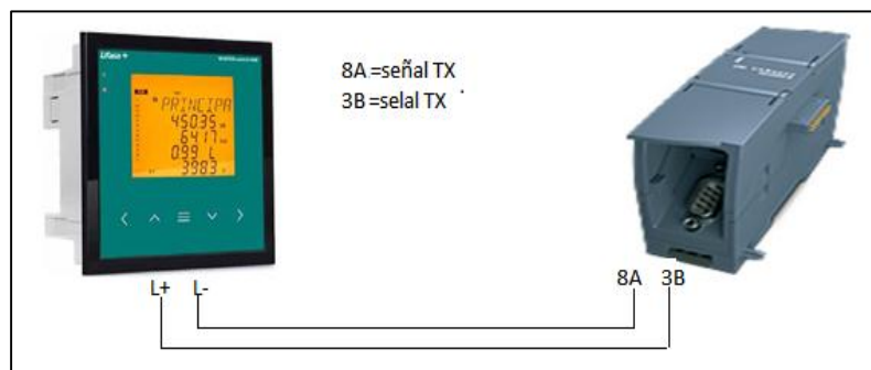
Figura 62: Conexión del Analizador MASTER CONTROL VAR y módulo de comunicación
