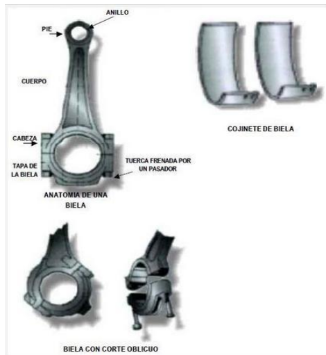
Figura 1. Partes de la biela
