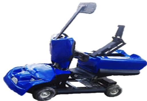
Fig. 16. Construcción de la silla bipedestador
