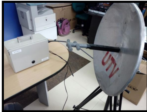
Figura 71. Caja exterior y antena transmisora de la señal microondas Fuente: Equipos del enlace microondas propiedad del canal universitario
