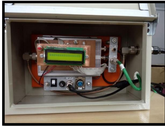
Figura 73. Caja externa con sus debidas conexiones a una fuente de alimentación, al frame de tarjetas análogas y ala antena transmisora
