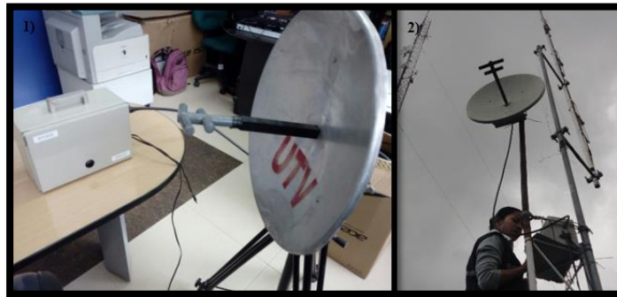
Figura 21. Antenas de transmisión y recepción del enlace microondas junto a sus respectivas cajas exteriores Fuente: Antena microondas transmisora y receptora perteneciente al canal universitario
