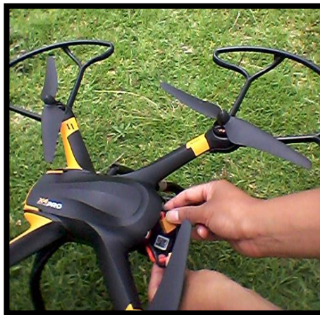
Figura 55. Conexión de la batería Li-Po del vehículo aéreo no tripulado para realizar el vuelo de prueba
