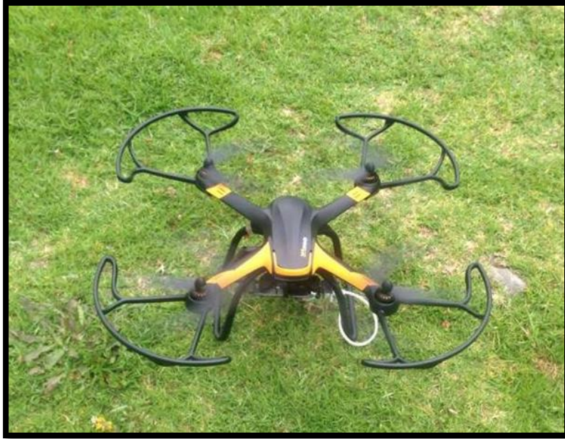
Figura 59. Vehículo aéreo no tripulado Hubsan X4 PRO equipado con el CC y listo para realizar la prueba de vuelo
