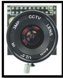
Fig. 3 Ejemplo de un módulo tipo cámara de Arducam
