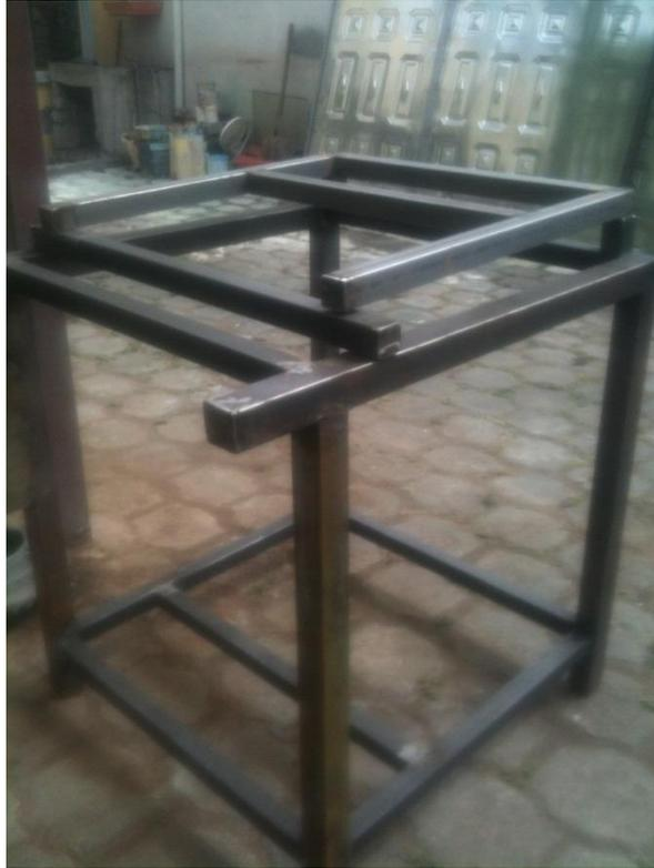
Figura 6.2 Vista isométrica del bastidor contruido
