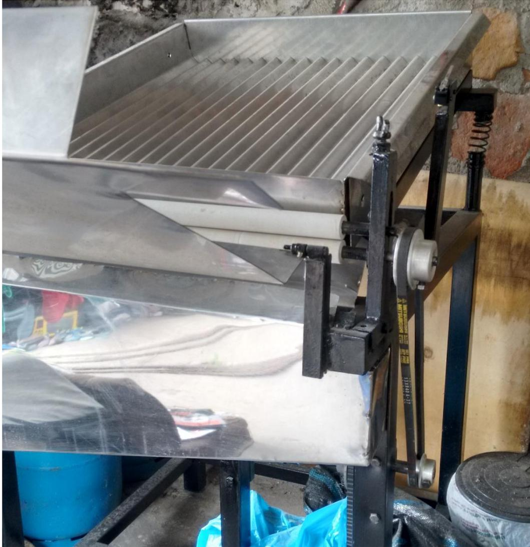
Figura 6.5 Vista del conjunto rodillo, poleas, bandejas de entada, tapa de protección
