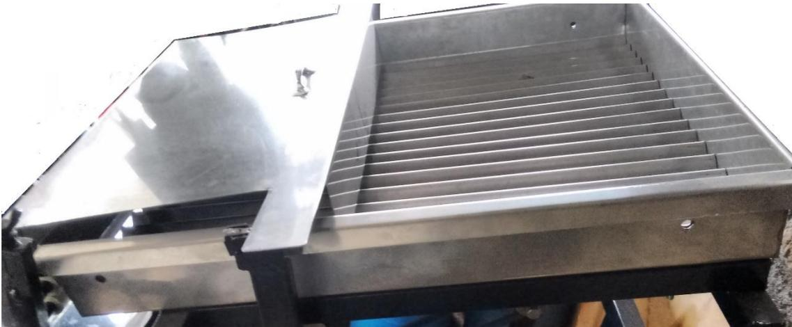
Figura 6.4 Montaje de las bandejas y tapa de protección sobre el bastidor
