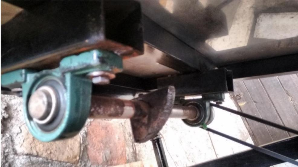
Figura 6.3 El eje y excéntrica usada en la maquina
