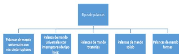
Figura 3 Clasificación de palancas de mando
