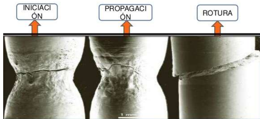
Figura 5 Fases de la falla por fatiga. [18]
