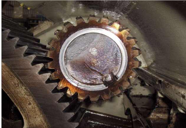
Figura 4 Pieza que falló por fatiga [15]
