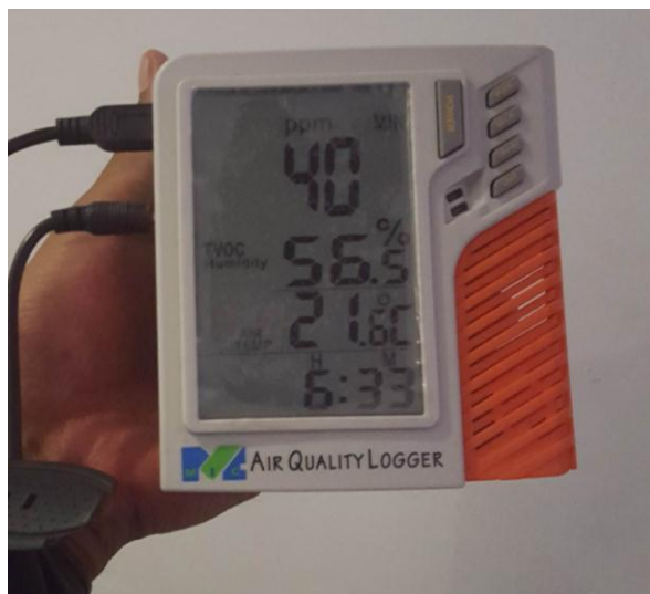
Ilustración 23. Air Quality Logger (Sensor electroquímico)
