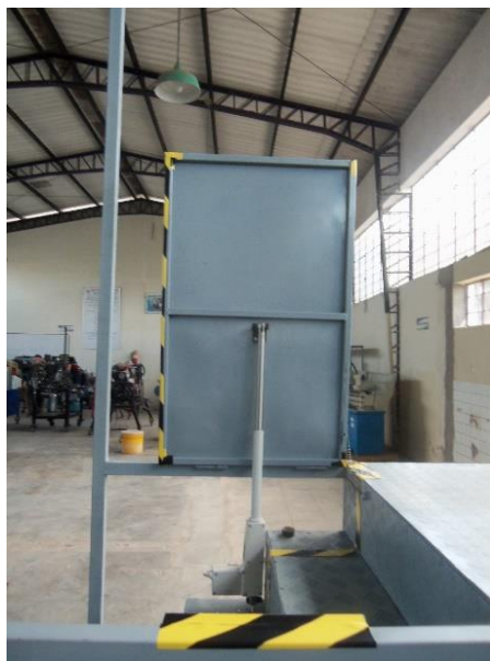
Figura 40. Rampa de acceso al interior del bus.
