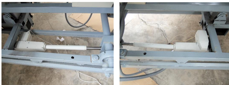
Figura 33. Posicionamiento de actuadores en la plataforma
