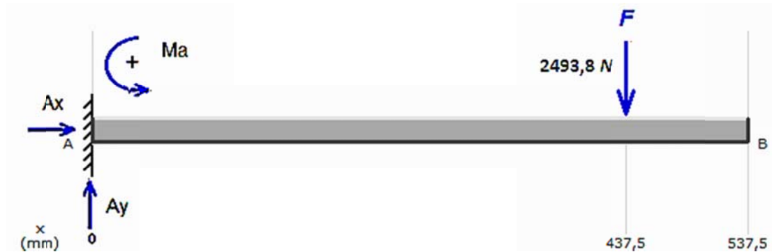
Figura 4.5. Diagrama de cuerpo libre de la sección del brazo giratorio.
