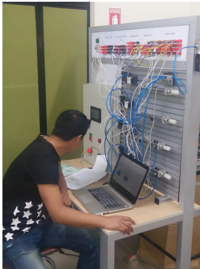
Estudiante descargando el software al PLC y Touch
