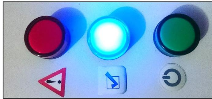
*Figura M 8. Indicador de correcto posicionamiento de los motores*
