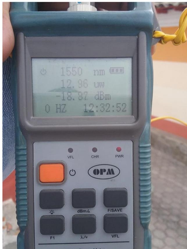
Figura 67. Medición de potencia desde la caja # 5 hacia el nodo
