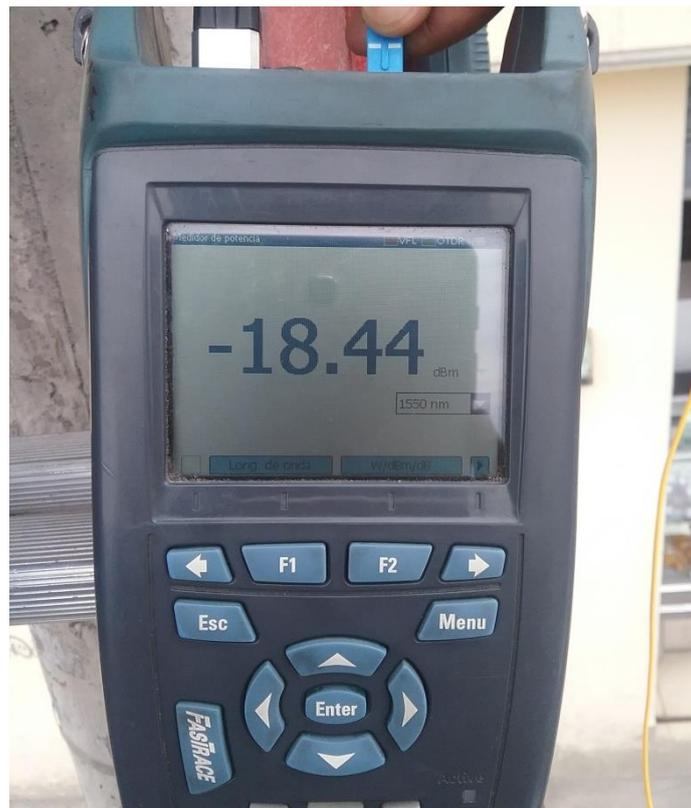
Figura 63. Medición de potencia desde la caja # 1 hacia el nodo
