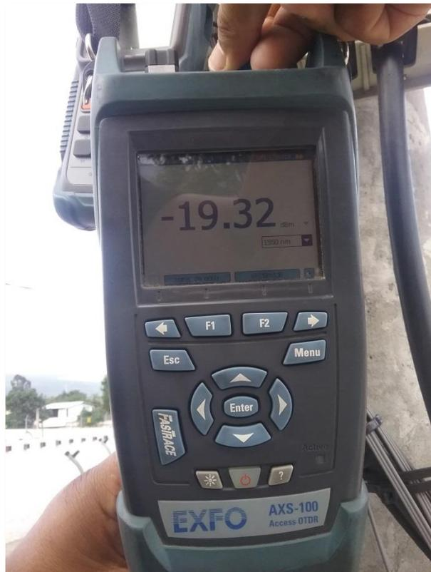
Figura 79. Medición de potencia desde la caja # 17 hacia el nodo
