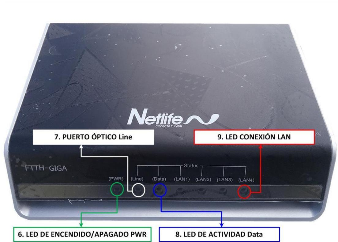
Figura 58. Parte frontal del equipo óptico de usuario final.
