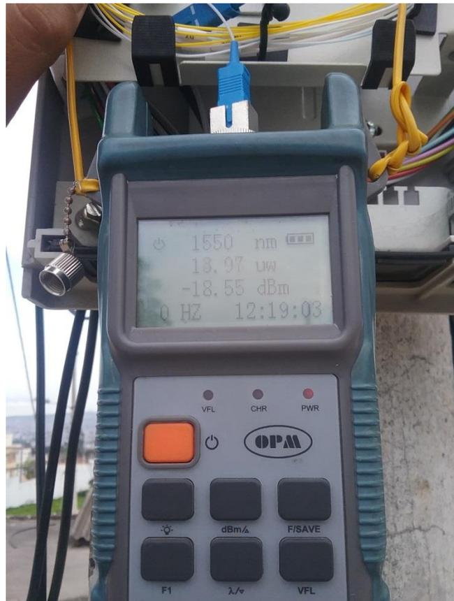
Figura 65. Medición de potencia desde la caja # 3 hacia el nodo
