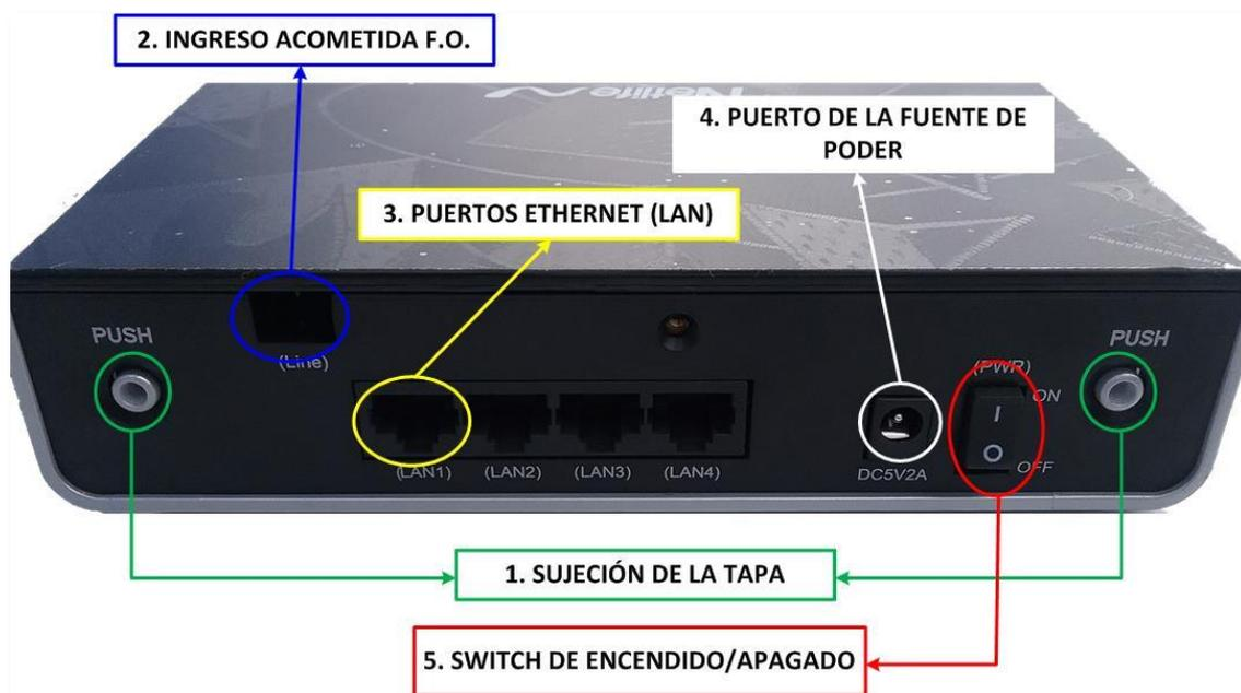
Figura 57. Parte posterior del equipo óptico de usuario final.
