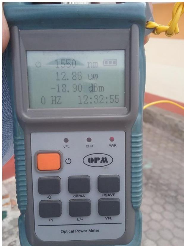
Figura 69. Medición de potencia desde la caja # 7 hacia el nodo
