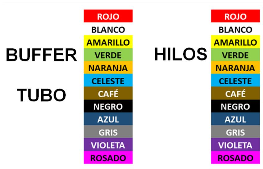
Figura 23. Color de buffers y de hilos del cable de fibra óptica de 144 hilos.
