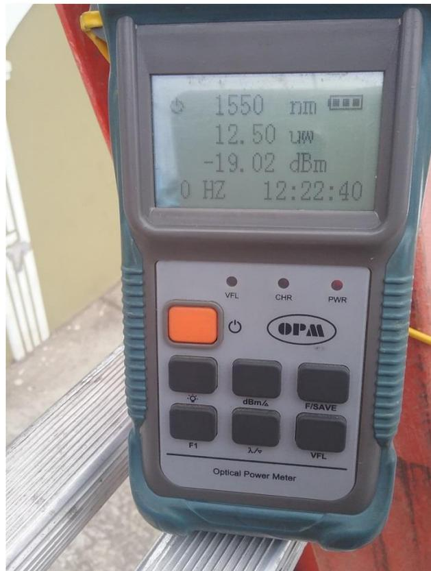
Figura 73. Medición de potencia desde la caja # 11 hacia el nodo
