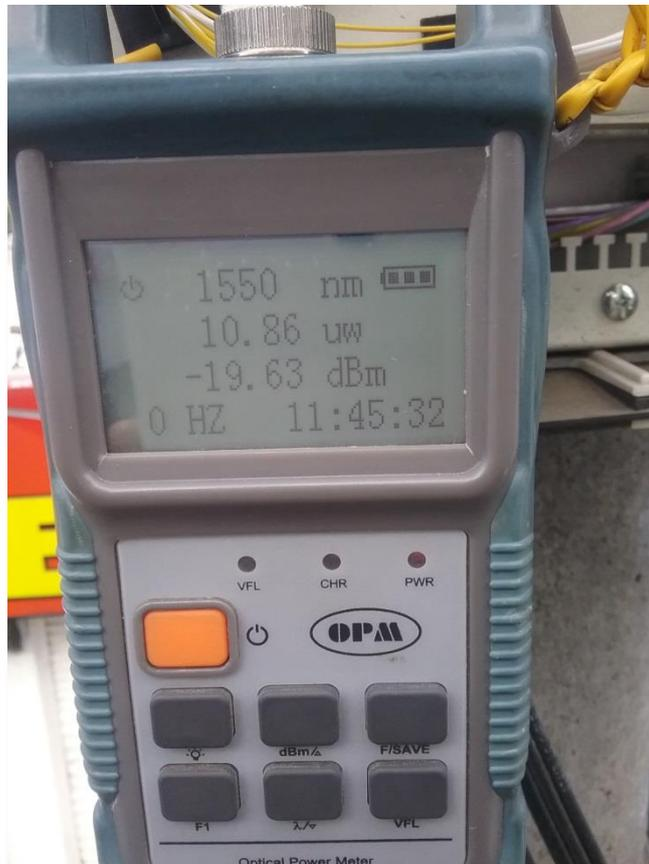
Figura 81. Medición de potencia desde la caja # 19 hacia el nodo
