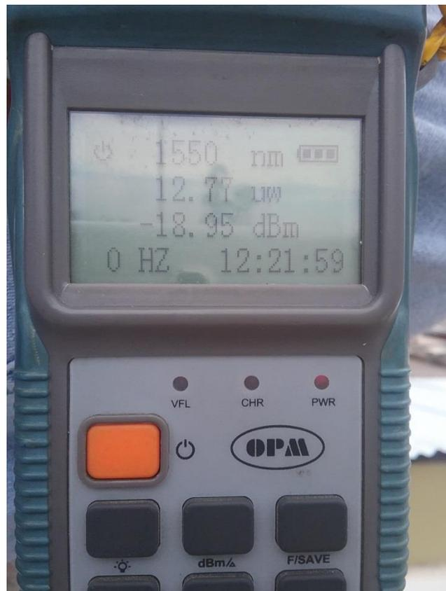
Figura 71. Medición de potencia desde la caja # 9 hacia el nodo
