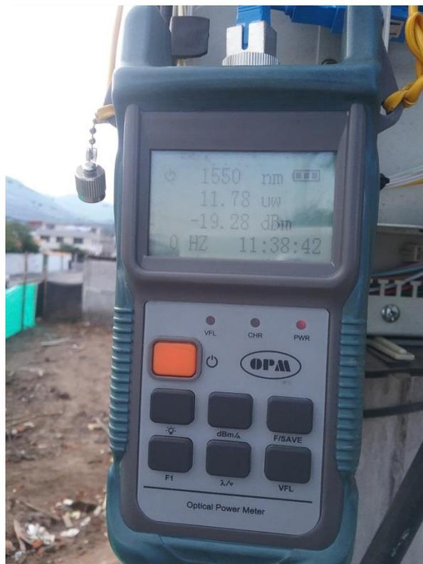
Figura 77. Medición de potencia desde la caja # 15 hacia el nodo
