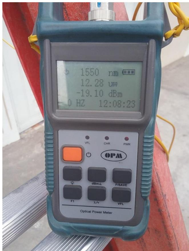
Figura 75. Medición de potencia desde la caja # 13 hacia el nodo
