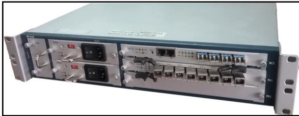
Figura # 6. Equipo OLT o equipo central óptico para una red Gpon.
