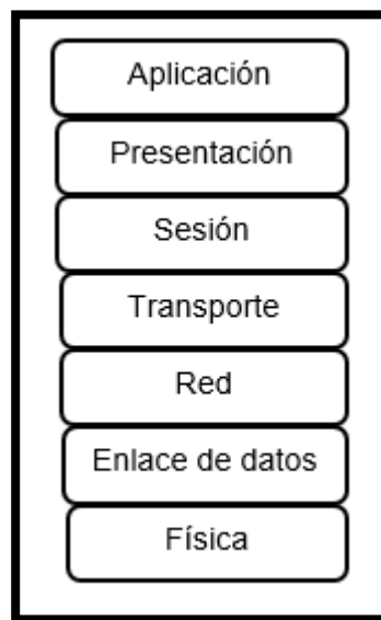
Imagen 1.-Capas del modelo de referencia ISO/OSI. Referencia: Andrew Tanenbaum, Redes de computadoras 2003.
