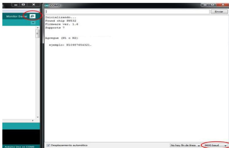
Figura 54: Paso 2, Iniciar monitor serial
