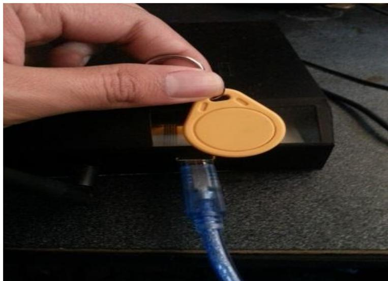
Figura 56: Paso 3, Acercar la tag Al dispositivo NFC
