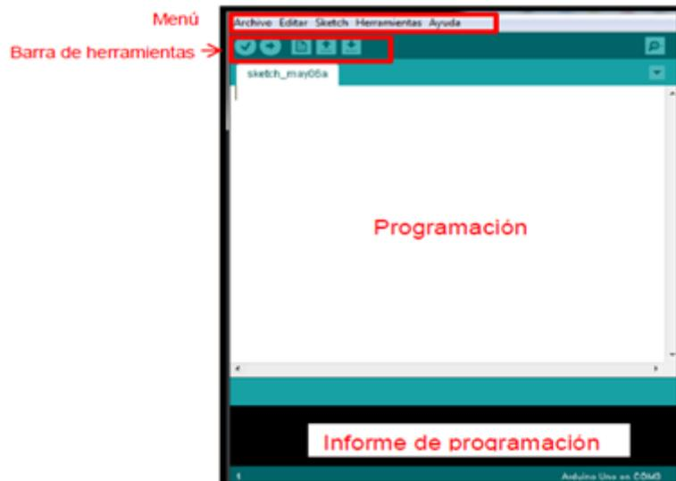
Figura 28: Interface gráfica Arduino
