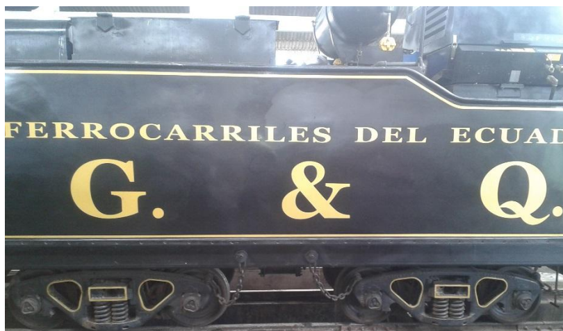
Figura 1: Tender de almacenamiento de agua
