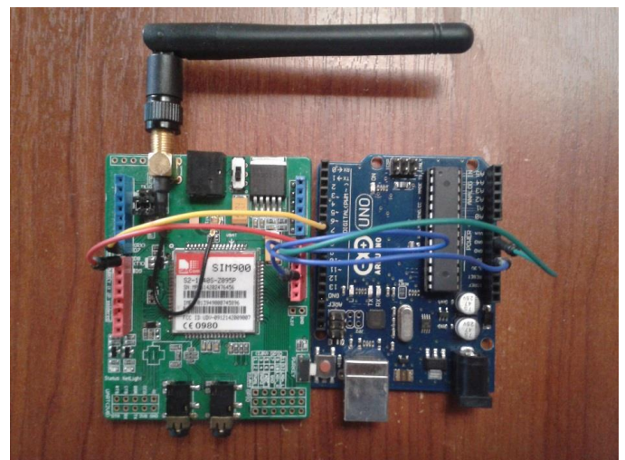
Fig. 4. Conexión ARDUINO con MODULO GSM/GPRS SIM900 – UART
