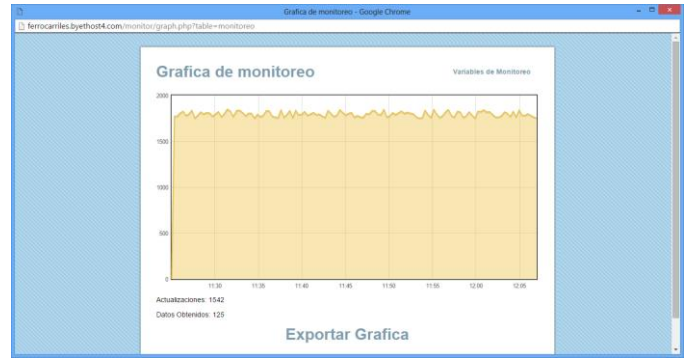
Fig. 31: Monitoreo de niveles de agua en la locomotora a vapor.
