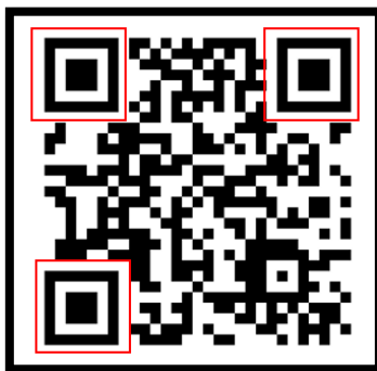
Figura 43: Estructura del código QR.
