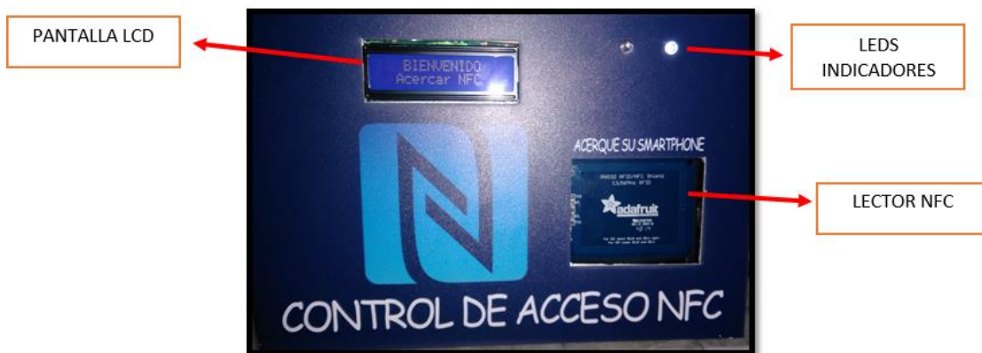
Figura 109: Componentes del sistema electrónico NFC.
