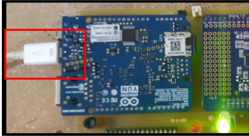
Figura 97: Conexión de la placa electrónica a la energía.
