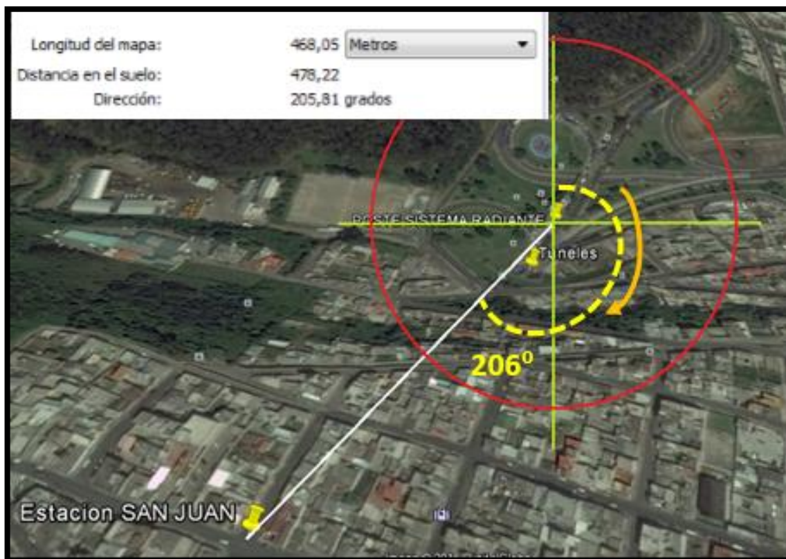
Figura 37 Ángulo de azimut de RRN del poste del sistema radiante en dirección a la estación San Juan Fuente: Elaborado por autor
