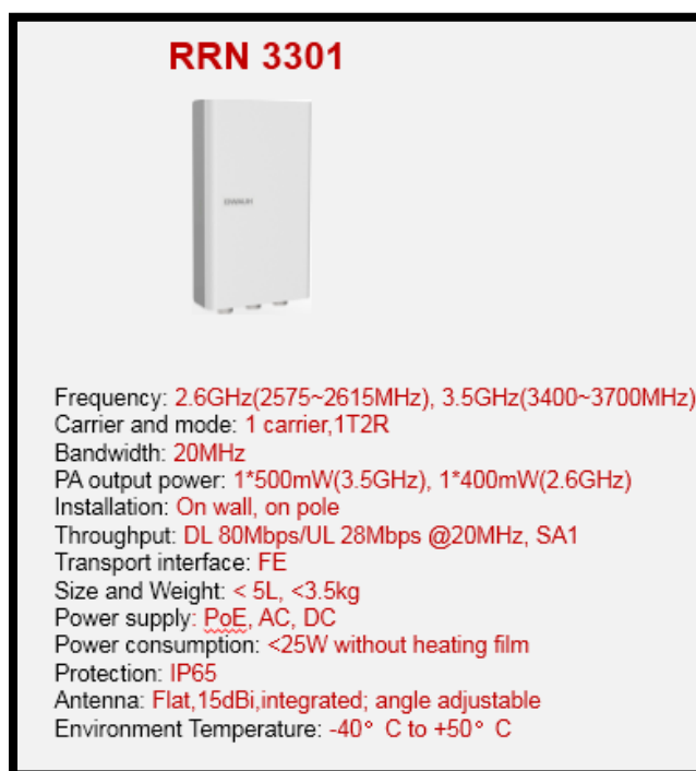
Figura 50 Especificaciones técnicas de la RRN 3301 Fuente: Base de datos Huawei
