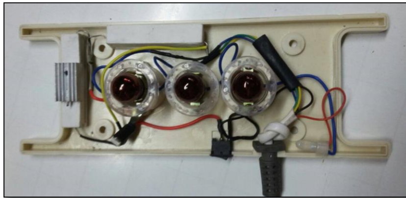
Figura 50: Circuito instalado en el módulo esferas para infrarrojo
