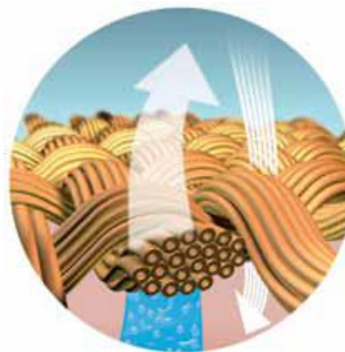
Gráfico 18: Microfilamentos de sección transversal hueca Fuente: (Advansa, 2011, p. 3)
