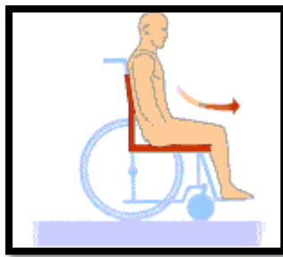
Figura 20. Profundidad excedida del asiento.
