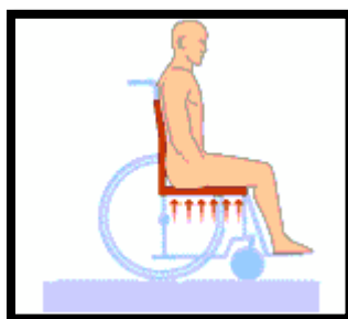
Figura 21. Profundidad óptima del asiento.
