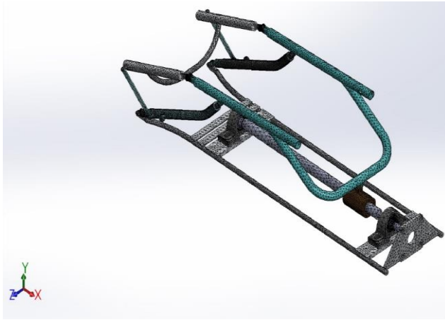
Figura 3. 35.Mallado de la estructura.
