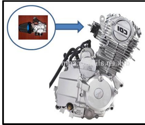
Figura 82. Instalación de colector de admisión en el motor.
