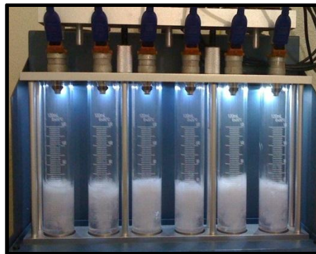
Figura 108. Banco de pruebas de inyectores.
