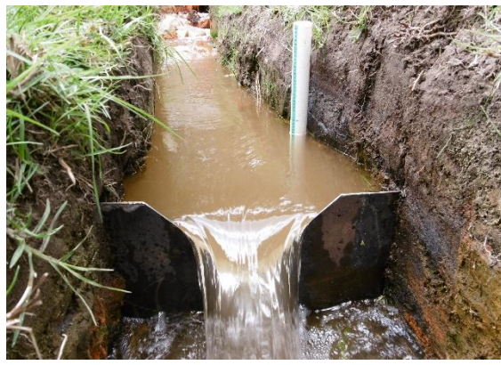
Fotografía 6. Medida de caudal de la fuente principal mediante el método de vertedero principal
