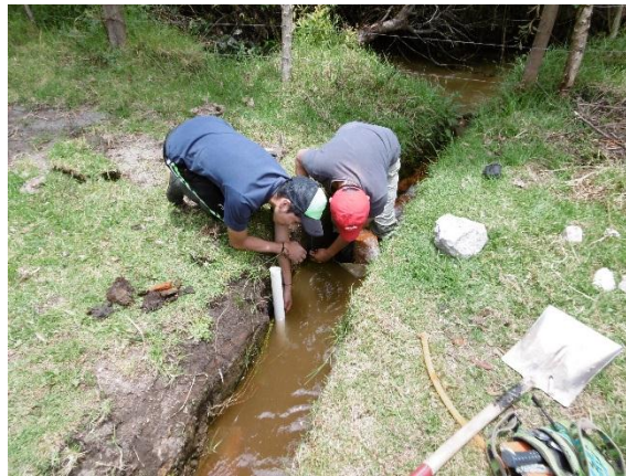
Figura 4. Medición de caudal mediante el método de vertedero triangular.
