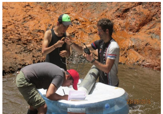
Fotografía 18: Toma de datos de velocidad, presión y temperatura, mediante el Testo 480
