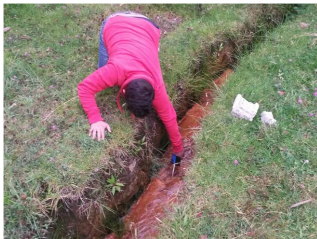
Figura 8. Medición de la concentración de los gases con la bomba draguer
