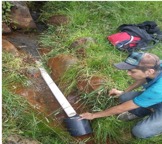
Figura 5. Medición de caudal mediante el método volumétrico
