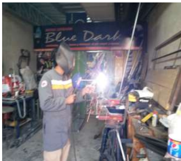
Figura 5.7: Soldadura del brazo superior
