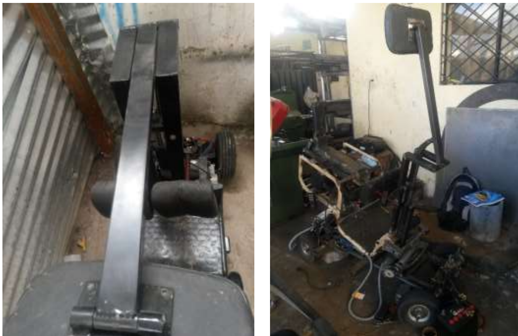
Figura 6.1: Posición inicial y final del actuador eléctrico.
