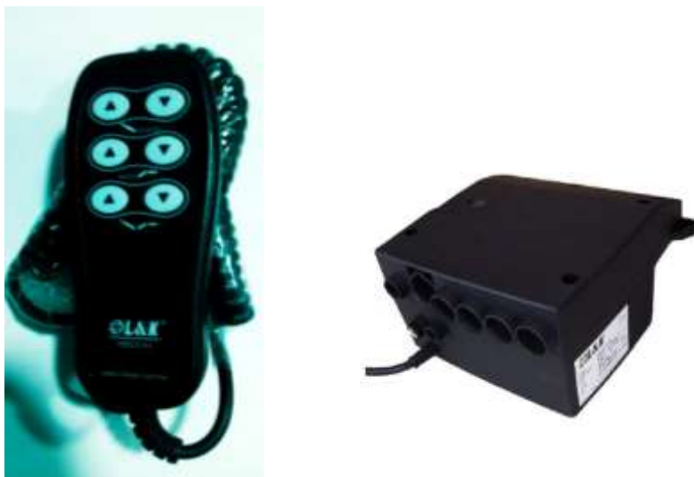
Figura 5.15: Control y Controlador del brazo bipedestador.
