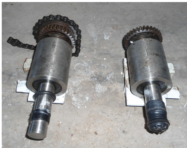
Figura 60 Ejes de desplazamiento
