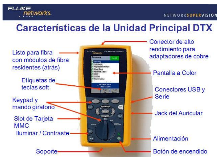
Figura 14 Características principales del Fluke Networks DTX-1800
