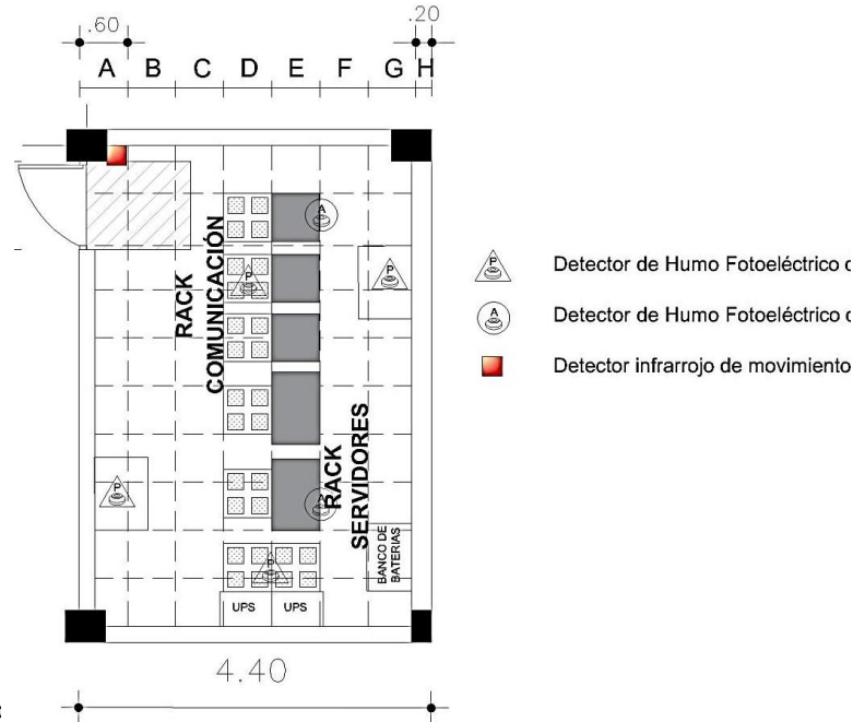
FIGURE IX UBICACIÓN DE LOS SENSORES DEL CPD. Fuente: Elaboración propia del autor
