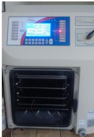
Figura 12. Equipo liofilizador “VirTis wizard 2.0” Fuente: Autor
