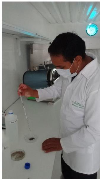
Figura 9 Preparación de muestras de suelo para inocular los medios de cultivo PDA y MEA.
