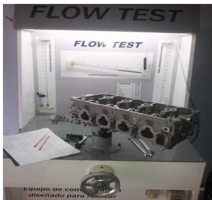
Fig. 9 Prueba de flujo de la culata estándar.
