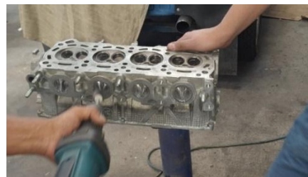
Fig. 10 Preparación de la culata.
