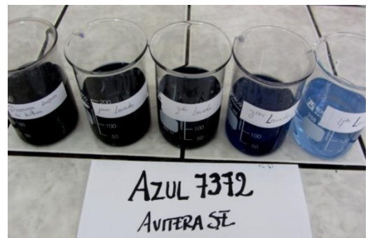
Figura N° 179 Muestras de los baños de lavados en un color bajo y un color fuerte, tintura realizada en planta con colorantes AVITERA SE Fuente: (Empresa Pinto S.A, 2016)
