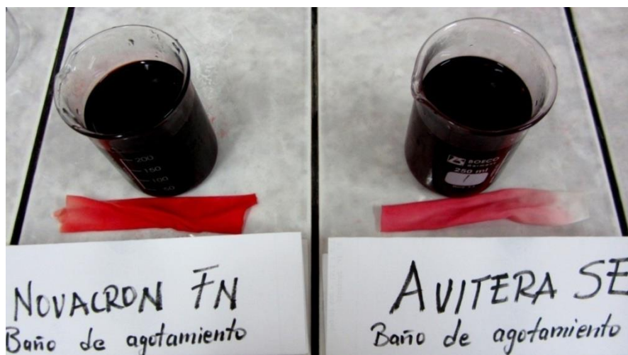
Figura N° 178 Muestra comparativa del baño residual después de la tintura con colorantes NOVACRON y colorantes AVITERA SE Fuente: (Empresa Pinto S.A, 2016)
