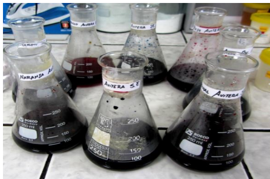
Figura N° 107 Soluciones listas 1gr de Colorantes en 100ml de agua Fuente: (Empresa Pinto S.A, 2016)
