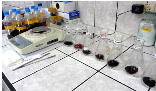
Figura N° 106 Colorante en polvo listo 1gr para realizar las soluciones Fuente: (Empresa Pinto S.A, 2016)
