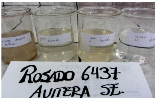
Figura N° 179 Muestras de los baños de lavados en un color bajo y un color fuerte, tintura realizada en planta con colorantes AVITERA SE Fuente: (Empresa Pinto S.A, 2016)
