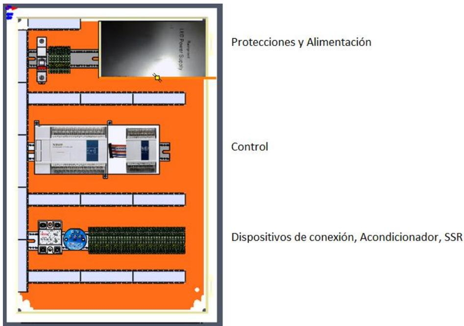
*Figura 21 Panel interno del tablero*
