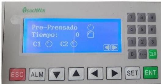
Figura 55 Pantalla de indicación de pre-prensado
