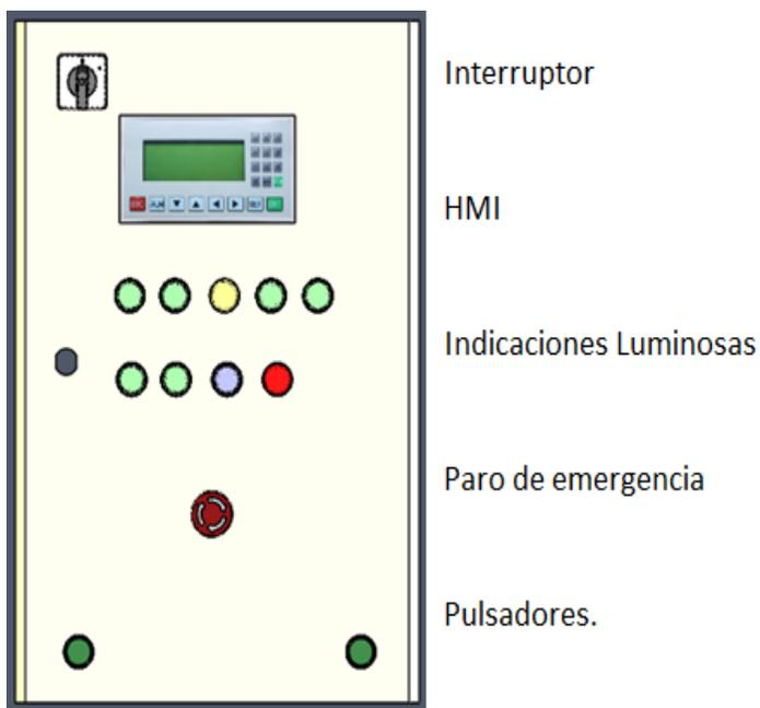
*Figura 20 Panel frontal del Tablero de control*
