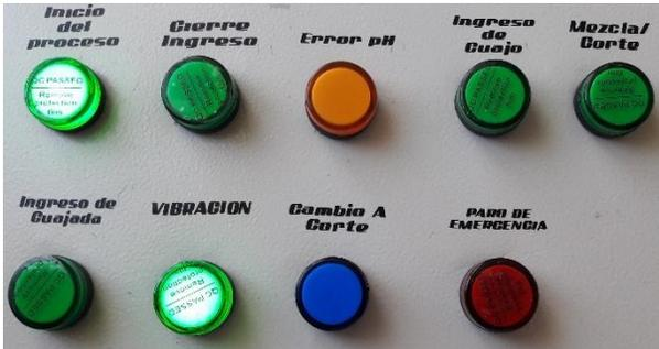
Figura 53 Señal luminosa de vibración activada
