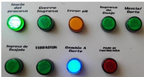
Figura 56 Indicación luminosa de cambio de herramienta de corte
