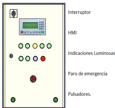
Fig 5 Panel frontal del Tablero de control
