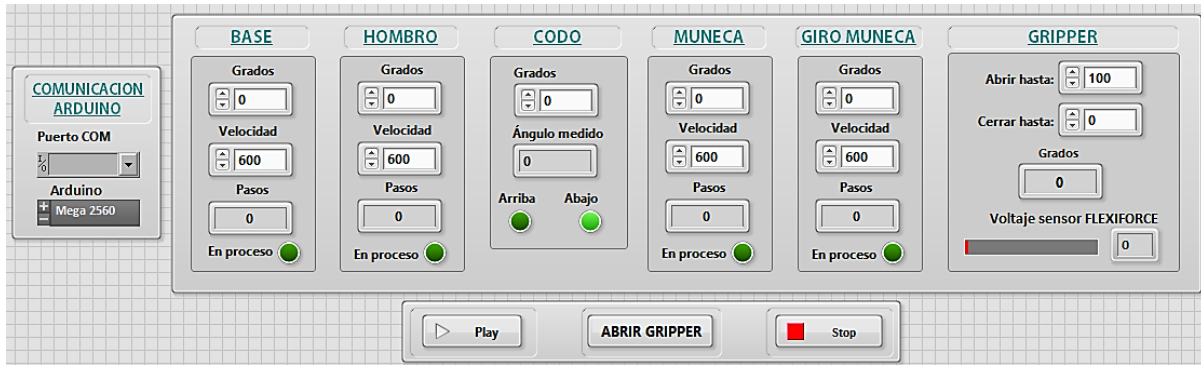
Figura 2.42. Interfaz gráfica del programa de control del brazo robot UTN.
