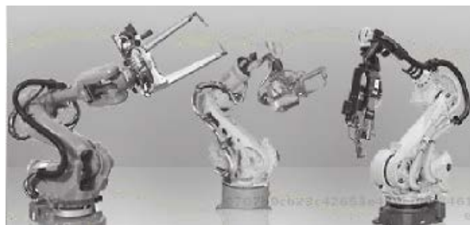
Figura 0.2. Brazos robóticos para procesos de pintura y suelda.
