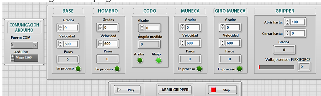
Interfaz gráfica del programa de control en LabVIEW en secuencia manual
