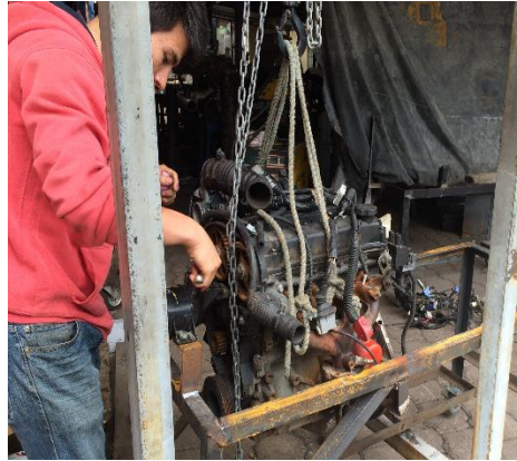
Figura 53: Montaje del motor.
