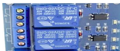
Figura 2: Módulo relé del tablero.
