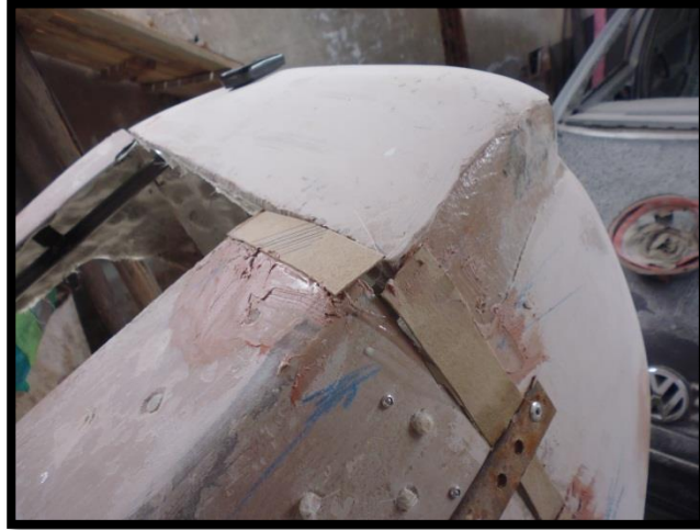
FIGURA 41: Colocación de la parte trasera
