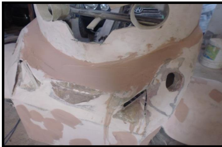
FIGURA 42: Colocación de la parte inferior
