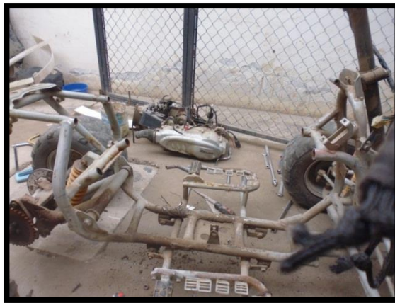
FIGURA 22: Corte de la estructura del chasis.
