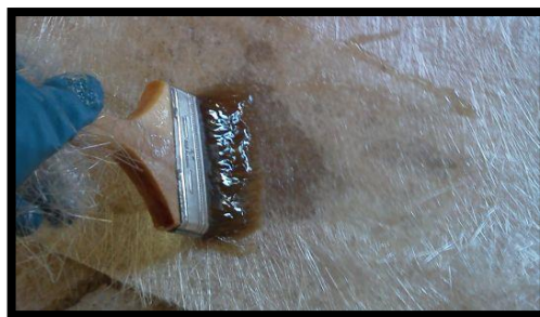
FIGURA 17: Forma de untar la resina en la fibra de vidrio.
