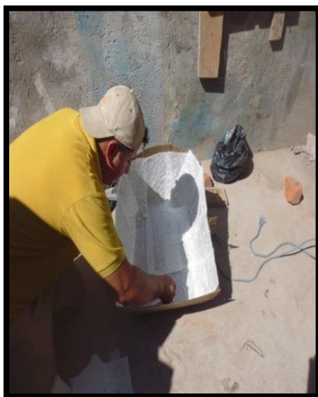
FIGURA 35: Extracción del molde de fibra de vidrio
