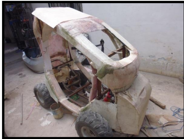
FIGURA 29: Uniones de fibra de vidrio
