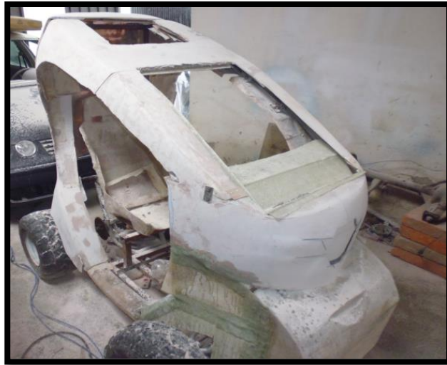
FIGURA 31: Centrado de la carrocería
