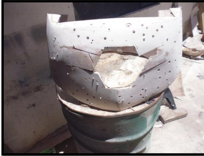
FIGURA 38: Perforado de todas las piezas
