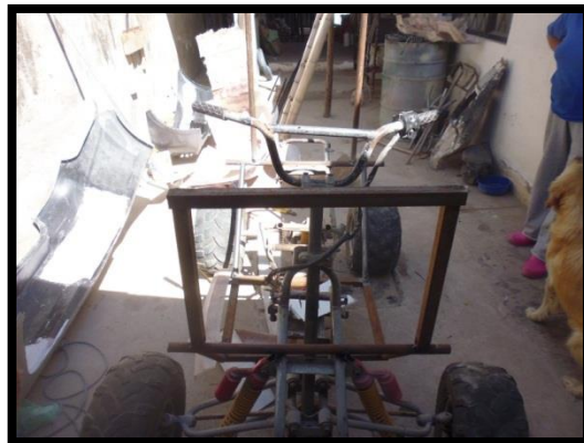
FIGURA 23: Adaptación del chasis parte delantera
