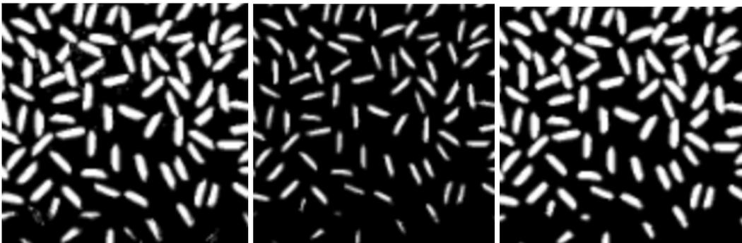
Figura 2.7: a) Imagen segmentada, b) erosión con elemento estructurante de disco de radio 2, c) apertura con elemento estructurante de disco de radio 2
